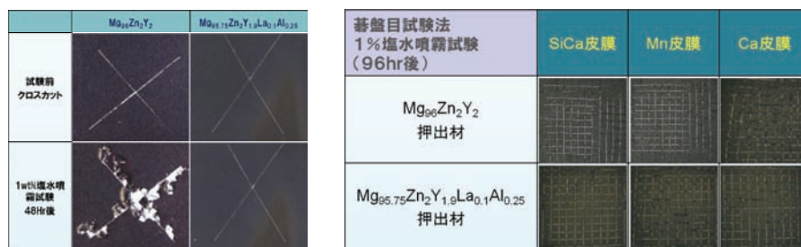
図3-11 表面処理材の耐食性
