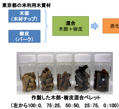
図3-1-1 木部と樹皮の混合による活性炭製造
