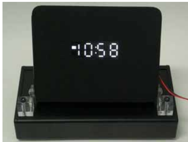
図 3 . 7 セグメントモノクロ LCD 表示例（第 1 回研究成果発表会）
