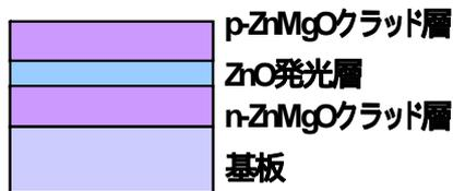
図1. ZnO 紫外 LED の基本構造。
