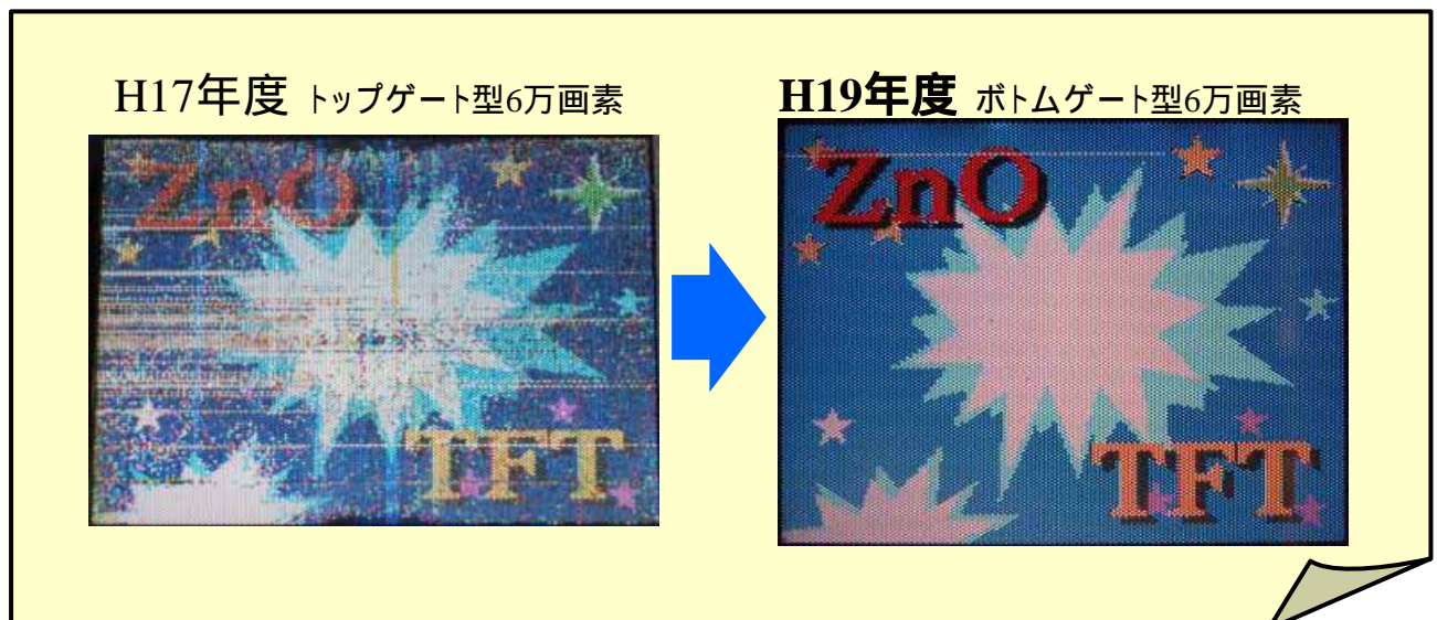
図 13 . ボトムゲート型 ZnO-LCD 表示
