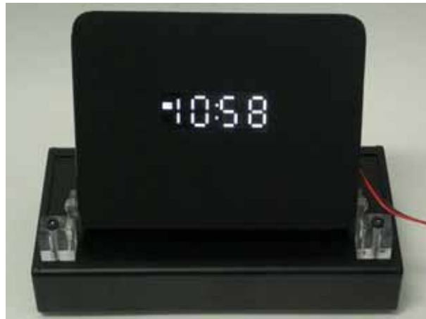
図 4 . 7 セグメントモノクロ LCD 表示
