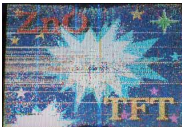
図9．トップゲート型 ZnO-LCD 表示
