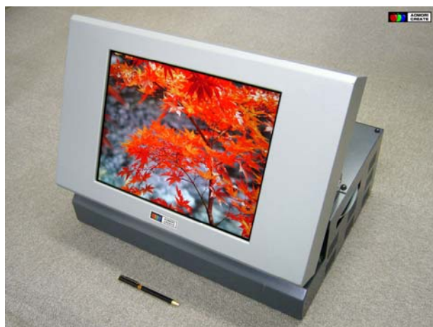
図5 試作開発した15型フィールド・シーケンシャル・カラーOCB液晶ディスプレイ
