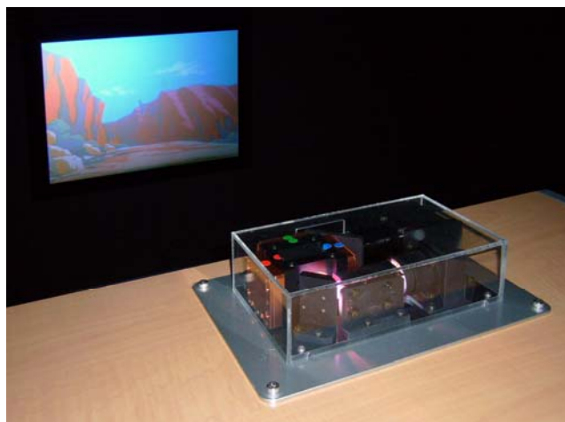
図6 開発試作したフィールド・シーケンシャル・カラーLCOS OCB プロジェクタ
