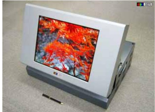
応用製品化において回路の雛型あるいはテストベッドとして有効利用できるようになっている。図 4 は実際に試作した 15 型 XGA 試作機である。バックライトとして、フェーズ で確立した直下型光学構造を採用し、一般の LCD より明るい 900~1000 cd/m<sup>2</sup> の表示輝度を実現した。またデジタルで高精度調光ができる LED 駆動回路を作成し、デジタル・カメラとパソコンで構成したシステムによる自動調光で、均一な輝度・色度を、白座標および輝度を指定しながら調整できるようにした。この試作機にて消費電力を測定し、30 型換算で 20W 以下の低消費電力液晶ディスプレイが実現可能であることを検証した。FS 方式の特長は低電力、高輝度、高精細、高彩度であり、試作機で十分視認することができる。
