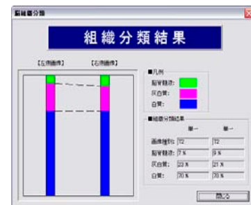
図4. 組織分類結果のグラフ表示画面 診断に有効な組織（脳脊髄液、灰白質、白質）別比率をグラフおよび数値表示することができます。
