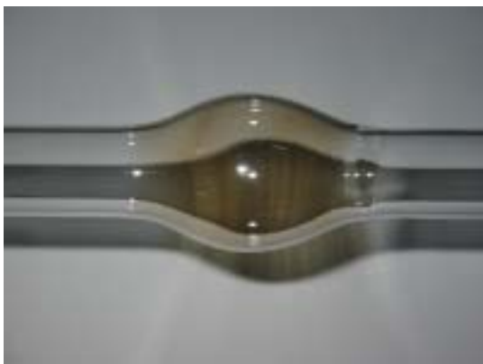
図 1 8 (a) レーザアブレーションによる成膜例 半導体処理装置光源用
