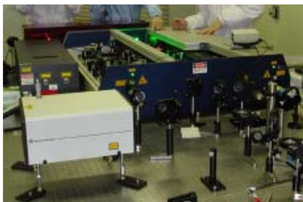
図 15 ナノ加工用フェムト秒レーザーシステム
