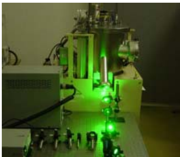
図.6 レーザ洗浄機能付きスパッタリング装置
