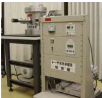
図.1 レーザ洗浄試験機(FNCT-1)(平成13年4月完成)
