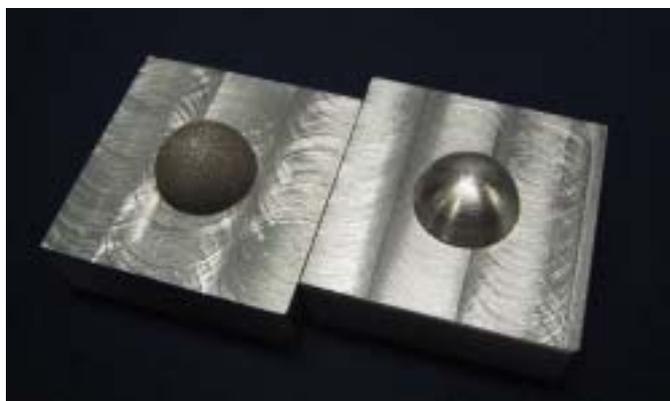
図 12 金属光造形と金属光造形複合加工比較
