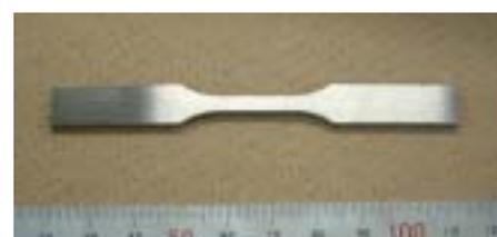
図 17 製作した JIS 7 号試験片
