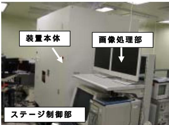
(a) ドライエッチング加工装置の全体図
