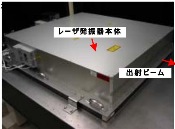
(a) Yb : YAG フェムト秒レーザーの概観図
