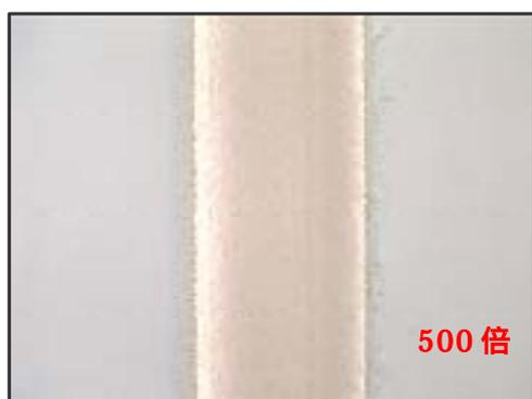
(a 1) ナノ秒レーザーによる加工結果の観察図
