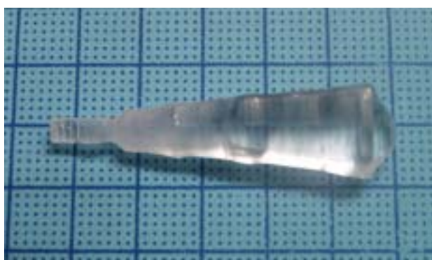
図 10 ZnO を 2wt%添加した育成原料から得られた Gd_xY_{1-x}COB 結晶 ( x=0.25 )。
