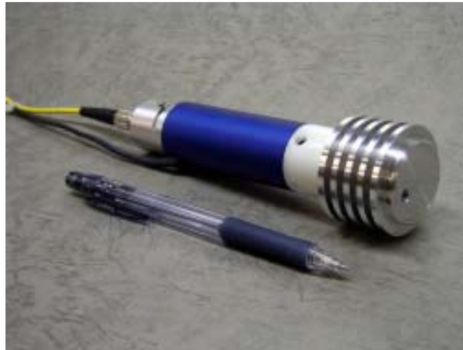
図 14 KTP-GdYCOB モノリシック波長変換素子を用いたペン型紫外レーザー。 ネオアーク（株）との共同研究にて製作。
