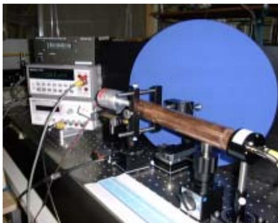
図11 長さ30cmの円錐ミラーの評価状況の写真
