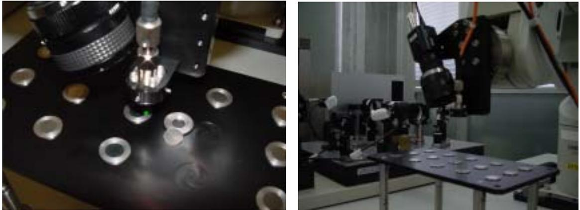
図 17 グリーンレーザーを用いて、ロボットを用いたレーザー加工の模擬実験の様子
