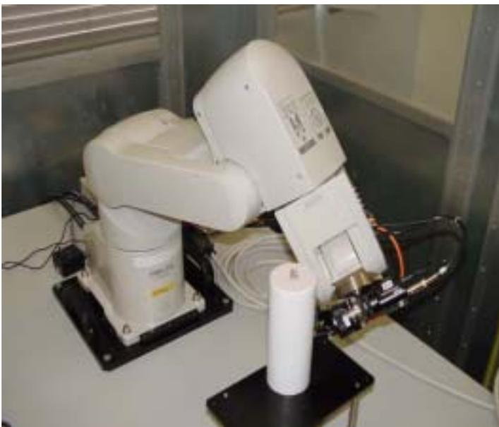
図 13 6 軸駆動ロボットによるレーザー加工系
