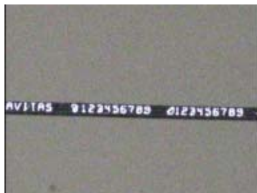
図14 モノフィラメントへのマーキング結果 ( 0.1 mmへ0.06 mm文字 )
