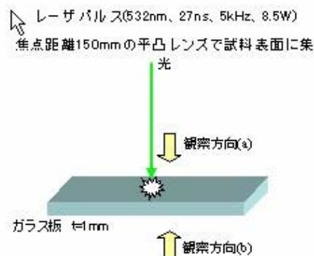
ガラス板への貫通穴加工
