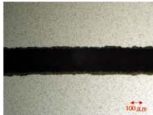
図 51 超硬チップ材料(ダイヤモンド層)への溝切加工 (溝深さ 100 \mu\text{m} は実体顕微鏡の合焦点位置の変化量から推測)
