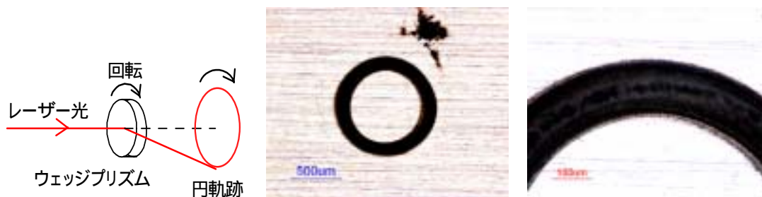
(a) ウェッジプリズム回転による (b) ステンレスへの加工結果 (c) (b)の拡大図 加工の原理
