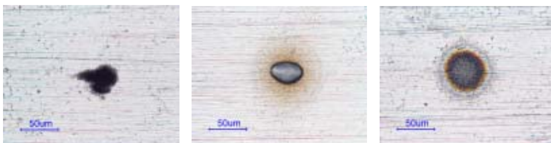
(a)レンズへの入射位置調整無 (b)レンズへの入射位置調整後 (c)アパーチャによるビーム切抜き 10uJ 1000pulses 1kHz 5uJ 125pulses 1kHz 5uJ 125pulses 1kHz
