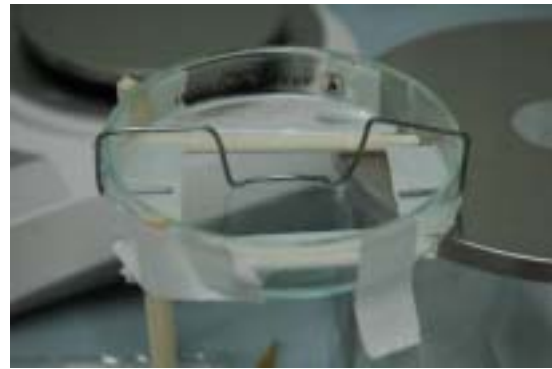
(b) テープのガイド機構を取り付けた溶液槽シャーレ
