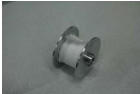
図 10 重水素化ポリスチレンを導入し、トルエンを揮発し終えたテープターゲット
