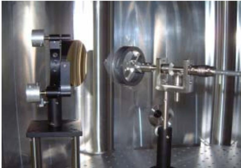
図3 真空環境実験装置内に設置された軸はずし放物面鏡と回転ターゲット
