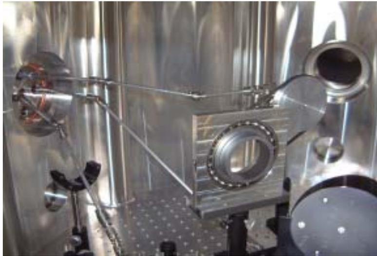
図5 改造したターゲット固定治具
