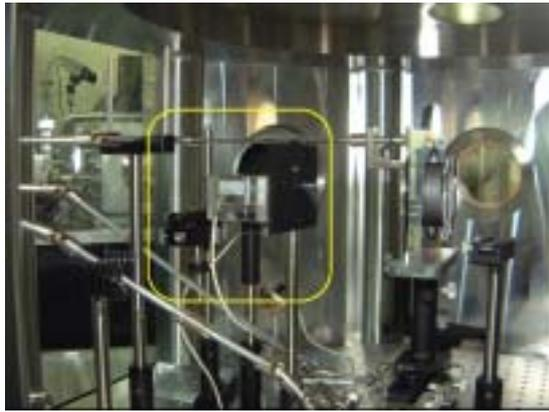
図 14 真空チャンバー内に設置されたトムソンパラボラ型イオン分析器(黄色い枠の中)
