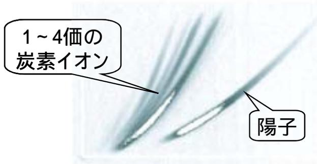
図 27 PTFE ターゲットから放出された各種粒子のトレース
