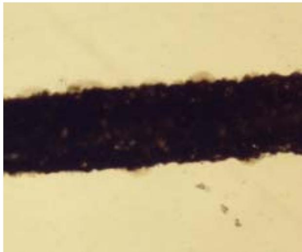
図 6 PET フィルム上に堆積したポリチオフェン細線の顕微鏡写真
