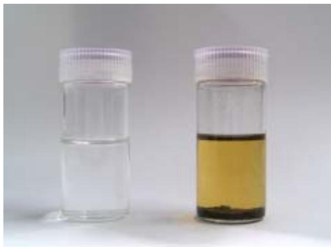
図 8 フェムト秒光パルス照射前後におけるチオフェン。左は照射前、右は照射後である。
