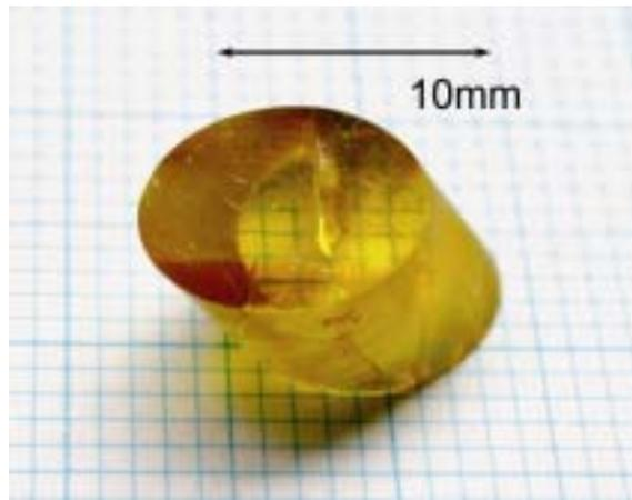
図 9 成長に成功した良質で大型の BNA 結晶
