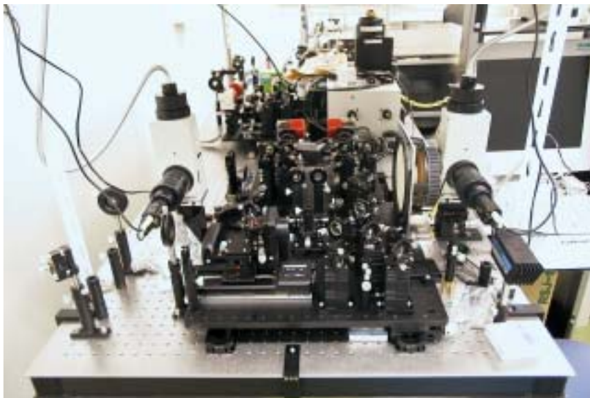
図1 THz波発生・計測の実験系
