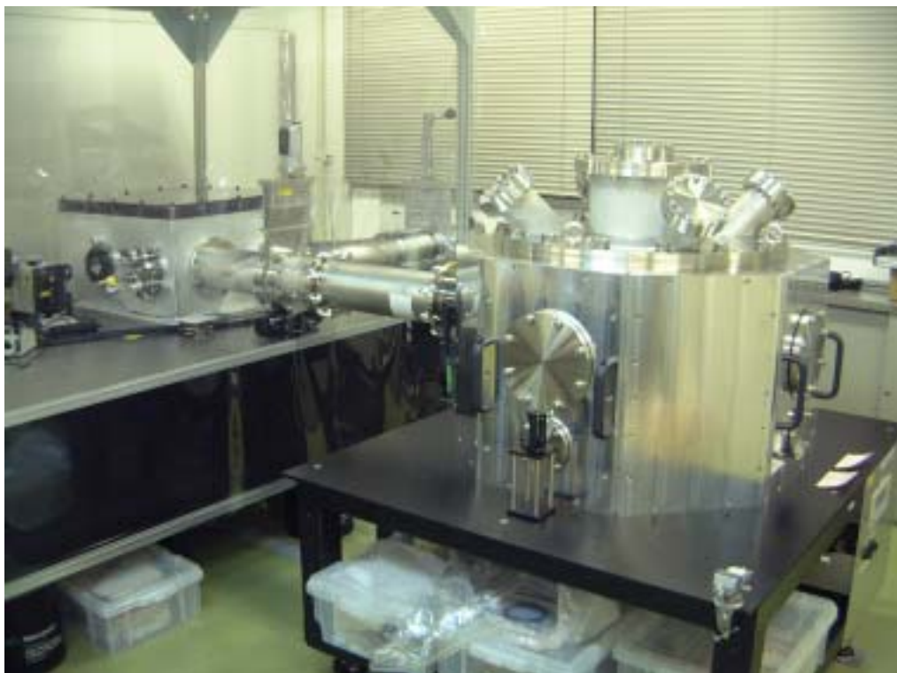
図12 高密度フォトン発生・実験装置と真空系で結合された真空環境実験装置
