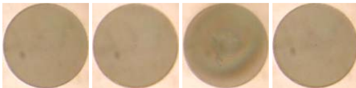
入射端面 出射端面 (g) 入射強度 58. mW、出射強度 24.2 mW
