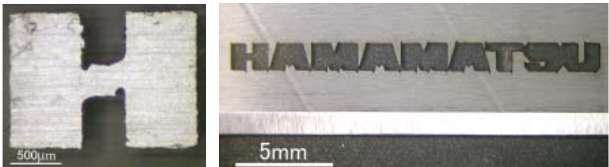
図 46 ファイバー出力パルス光による加工実験結果 (厚さ: 0.5mm、加工速度: 5 \mu\text{m}/\text{sec} )
