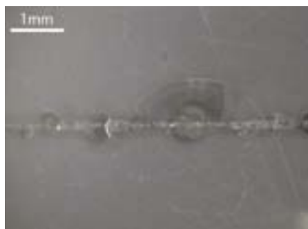
図 48 Yb ファイバーレーザー（中心波長 1085 nm、光強度 80 W）による加工結果
