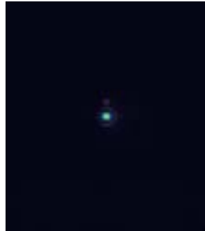
図 43 レーザー出力光を集光した場合のビームスポット形状計測結果 (横 : 247 \mu\text{m} × 縦 : 280 \mu\text{m} )
