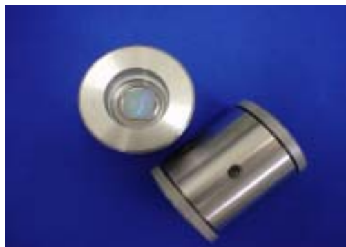
図4 ステンレス容器に内蔵したフォトニック結晶
