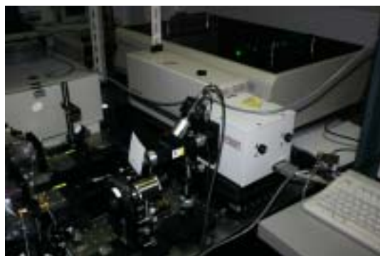
図5 フォトニック結晶の波長分散評価実験装置の写真
