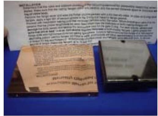
図 15 銅鏡面研磨台と抵抗発熱体のヒートシンク部の写真。その鏡面精度の差が明らかである。
