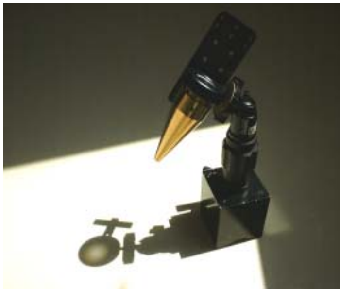
図21 レンズ付き金属円錐鏡のホルダー取り付け写真
