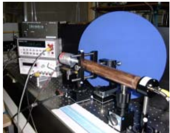
図 18 長さ 30\text{ cm} の円錐ミラーの評価状況の写真
