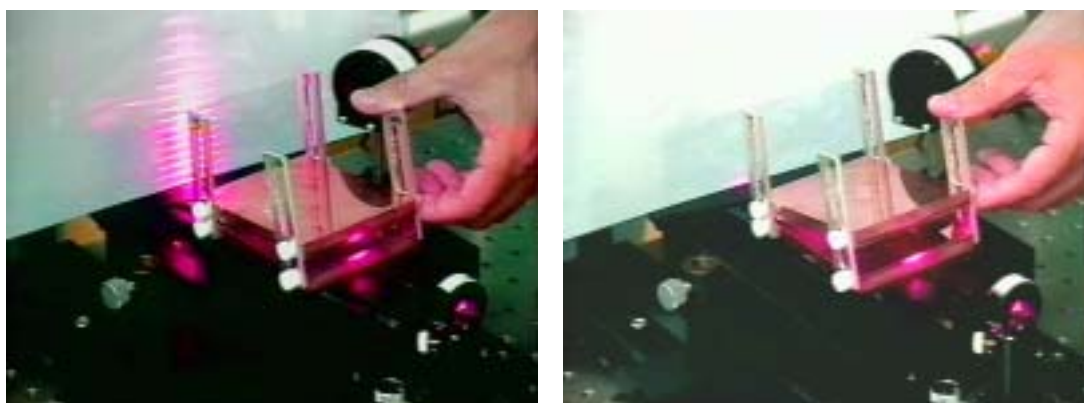
図8 銅鏡のなす角度を変えたときの出射状態の写真
