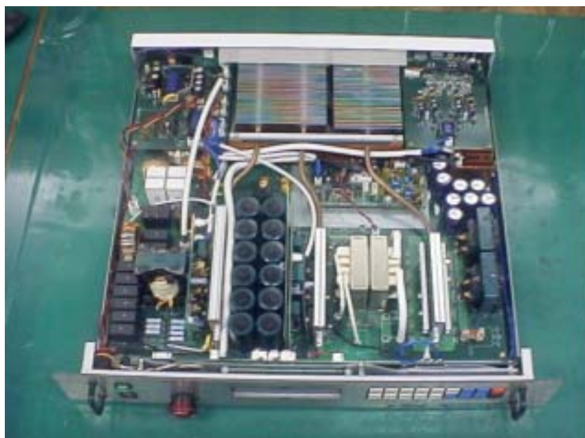
図4 開発が終了した高機能高出力安定化直流電源の内部構造
