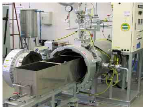
図4 蒸気処理装置の外観
