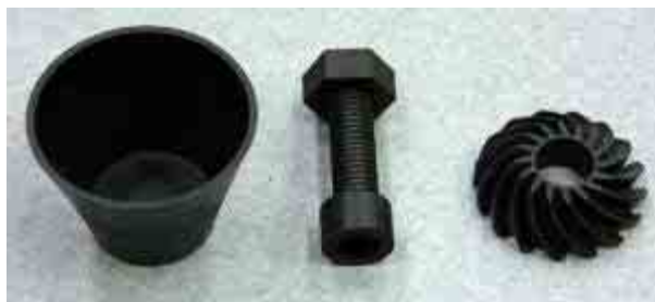
カップ(成形) ボルト(成形) かさ歯車(切削)
