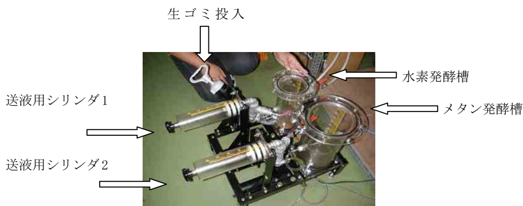
図 8. 二槽分離循環型メタン発酵装置の各部説明
