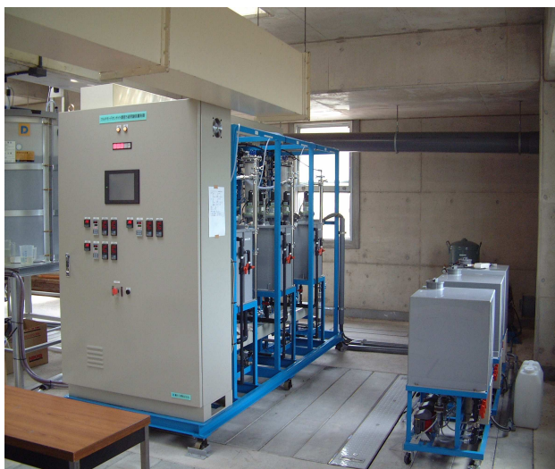
図 13 オンサイトマルチモード精密濾過装置
