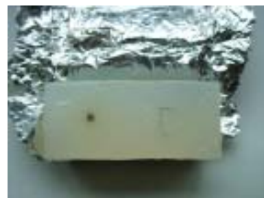
図2. 試験サンプル(アルミ箔中の寒天食品の中の金属異物(球、ホチキス針))
