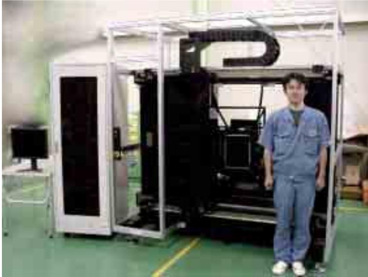
検査機本体 大きさW2100×D1300×H2200mm、重量 1500kg
