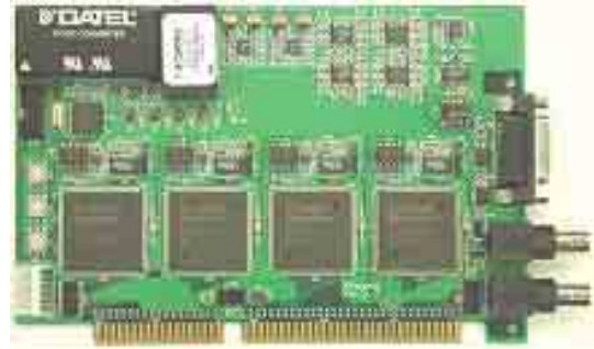
図8 異常放電検出ボード
