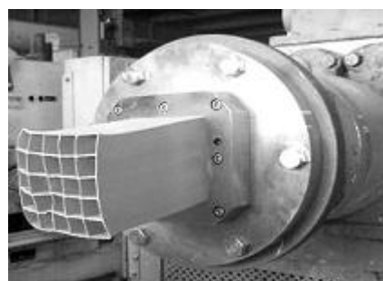
図 4 ハニカム(5 × 5セル)の成形
