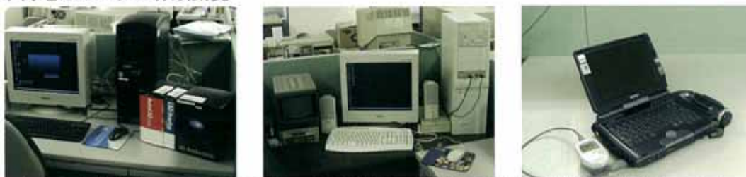
図 25 左から 3次元データ処理システム、画像取得・処理システム、現地位置取得システム
