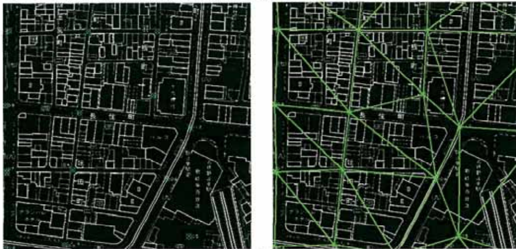
図 35 標高点データ、最適三角形分割による地形モデル
