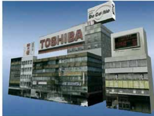
図 53 イメージベースドモデリングによる詳細建物モデル
