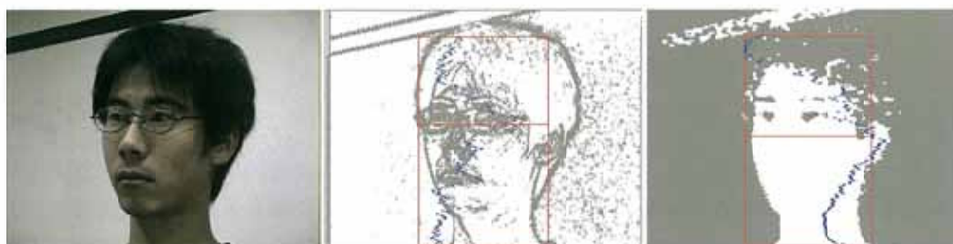
図 15 目、および耳の高さの検出
