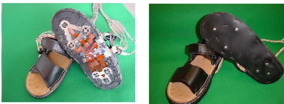
図 21 計測に用いた靴底ベクトル荷重センサ
