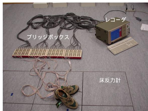
図 17 測定装置と床反力計
