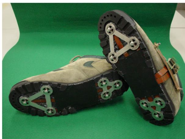
図 16 靴底ベクトル荷重センサ
