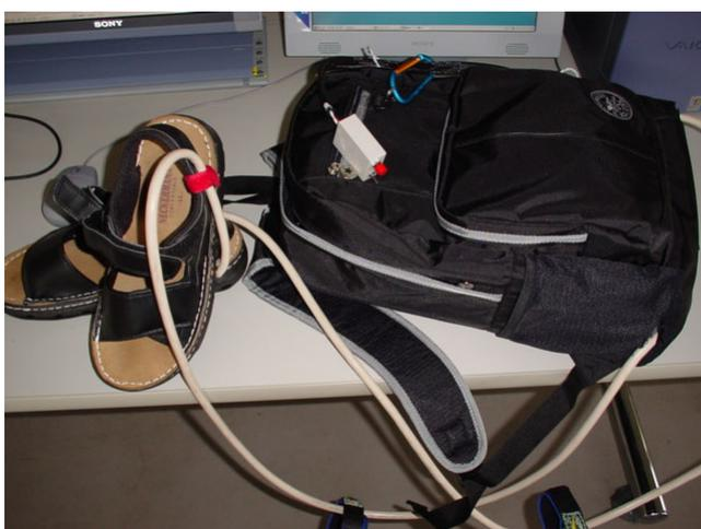
図 26 靴底ベクトル荷重センサシステム
