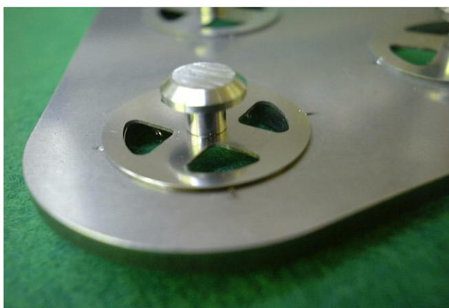
図 11 ダイアフラム型ベクトル荷重センサ素子
