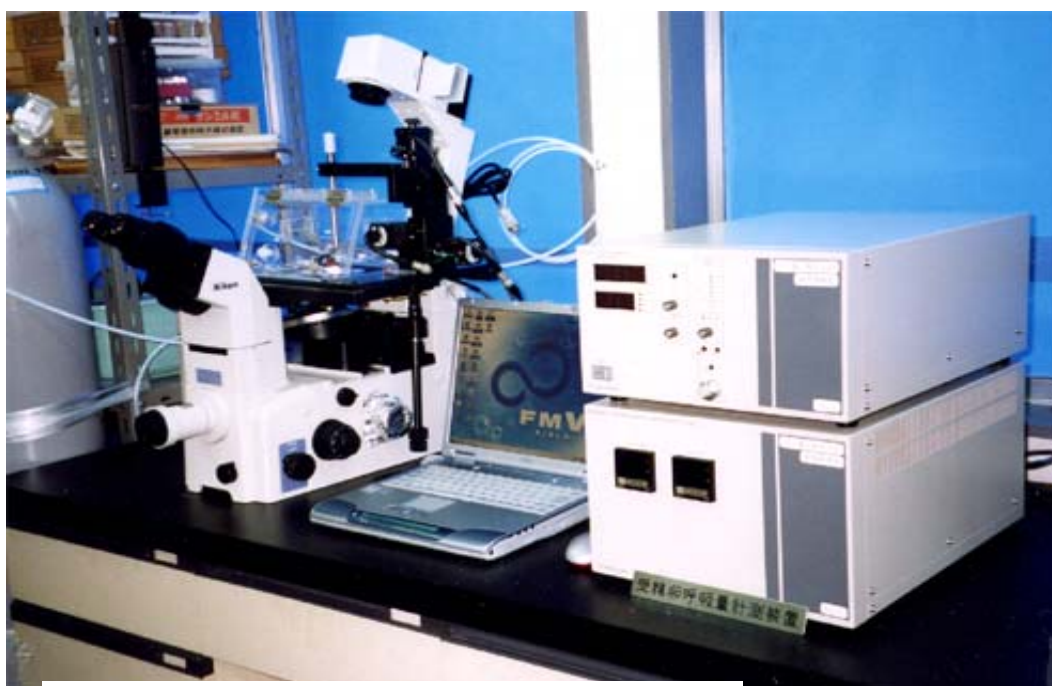
図4 受精卵呼吸測定装置（北斗電工株式会社）
