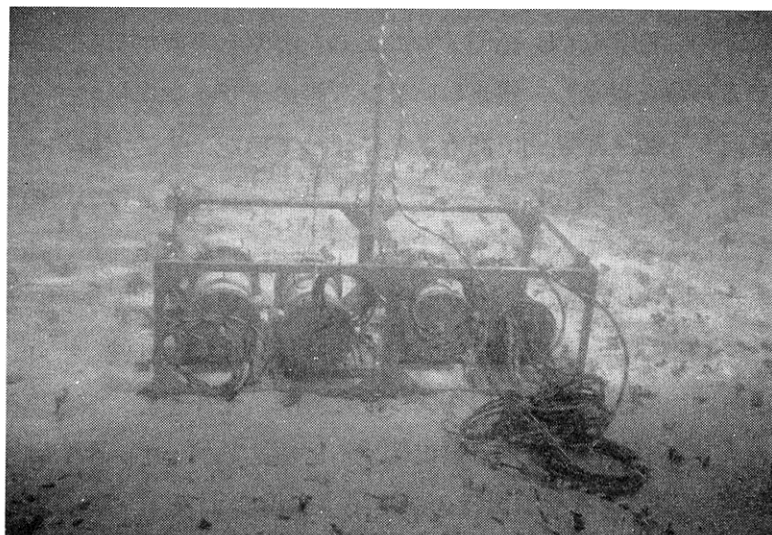
写真2 水没型CO 2 計測システム。パラオ諸島サンゴ礁において、1999年11月から2000年11月まで1年間の通年観測を行なった。測定機本体は左端のもので、他の3つは電池ボックス。電源は市販の電池を1419個収納した。消費電力は15W。
