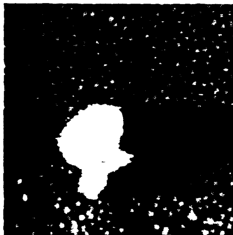
図IV.1.41 探針に負のパルス電圧を印加したときの Si(111)7×7 表面の変化(パルス幅:1.67 \mu s, 電圧:-20V)
