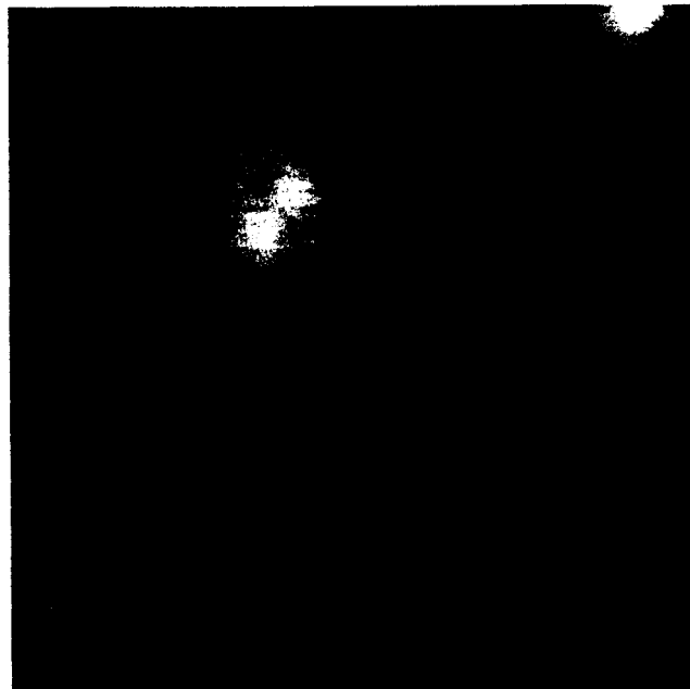
図Ⅱ.5.39 Cu 吸着 Si(001)2×1 表面の STM 計測結果 (サンプルバイアス：-1.8V、スキャン範囲：7×7nm 2 )
