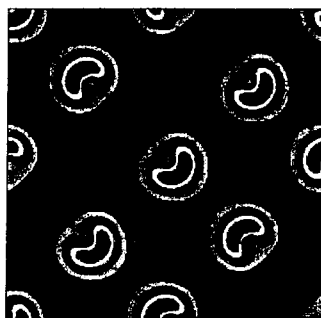
図 II.5.11 Cl 吸着 Si(001)表面(被服率 1)の STM 像のシミュレーション結果 (価電子帯側 : V_s = -2.5V )
