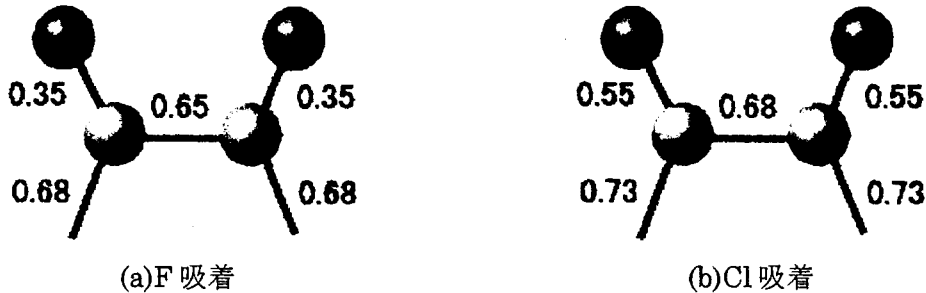
図 II.3.18 F,Cl 吸着 Si(001)2×1 表面(被覆率 1)のボンドポピュレーション
