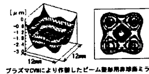
プラズマCVMにより作製したビーム整形用非球面ミラー
