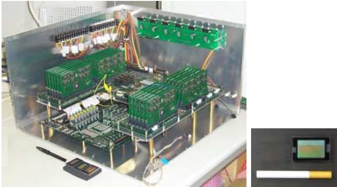
図2 光計測装置タイプ2の概観(左)と、カスタムCCDセンサ(右)
