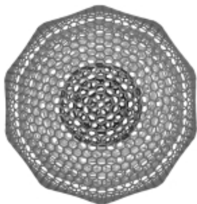
1 MM3による機械的構造最適化処理を施した9層ナノオニオン
